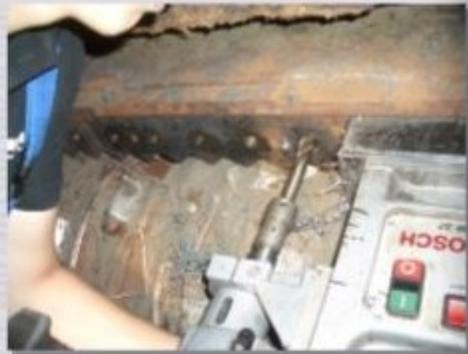
.....einsetzen von Helicoils für M 20 Gewindebolzen in einen Schredder für Wertstoffe
